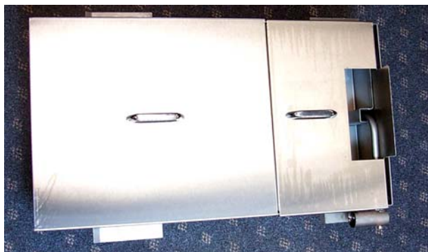
Prawidłowo umieszczone pokrywy miski.
