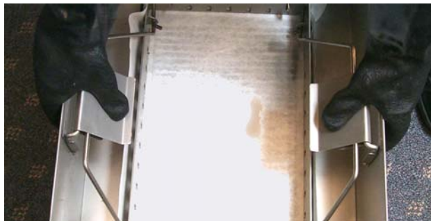
Zatrzaski na pierścieniu dociskającym.
