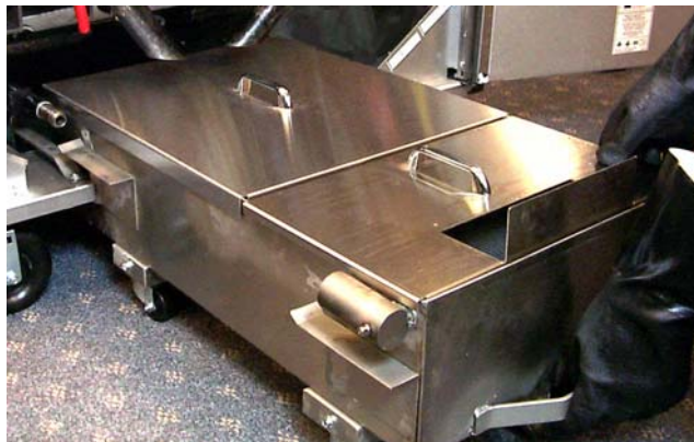
Umieszczanie miski filtru w szafce. Filtr jest gotowy do pracy.
